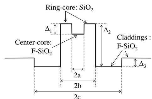
Figure 1: Structure of PSCF-130. Typically  $\Delta_1=0.1\%$ 、 $\Delta_2=0.34\%$ 、 $\Delta_3=0.1\%$ 、 $b/a=2.5$ 、 $2b=12\mu\text{m}$ 、 $c/b=3.5$
